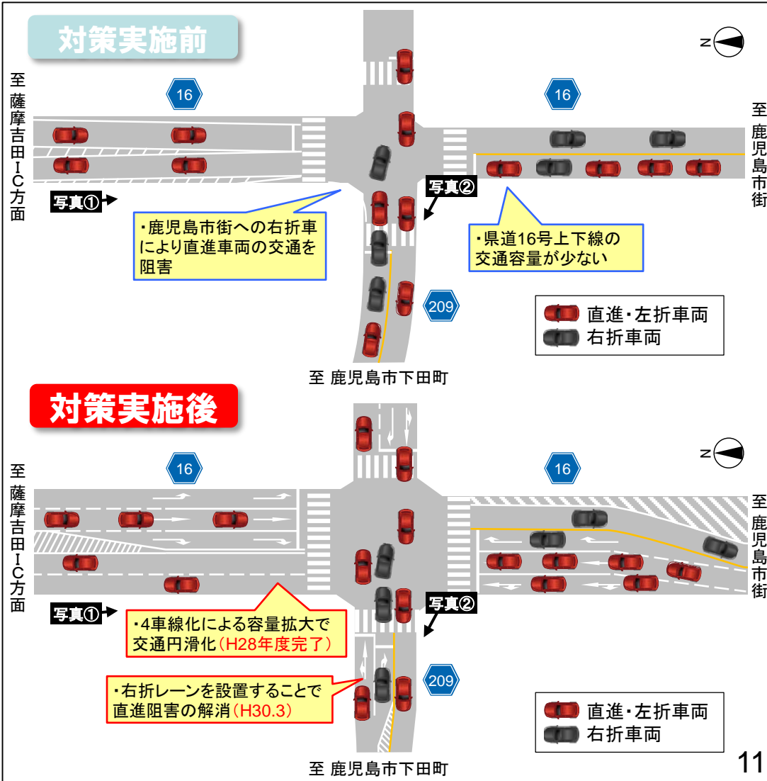
《説明図》 対策:4車線拡幅、右折レーン設置
