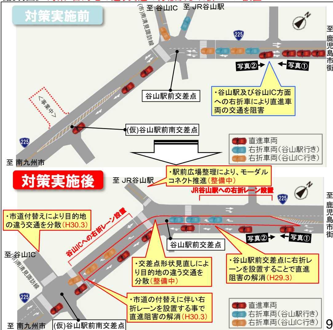
《説明図》 対策：目的地の違う交通の分散及び右折レーン設置
