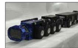
下水道管路の欠陥を画像認識技術により自動検出するロボット
