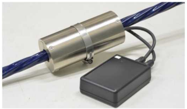
▲ケーブルの張力を計測
