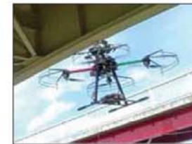
道路橋の損傷写真を撮影するカメラを搭載したドローン
