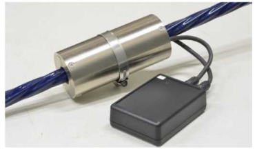
▲ケーブルの張力を計測
