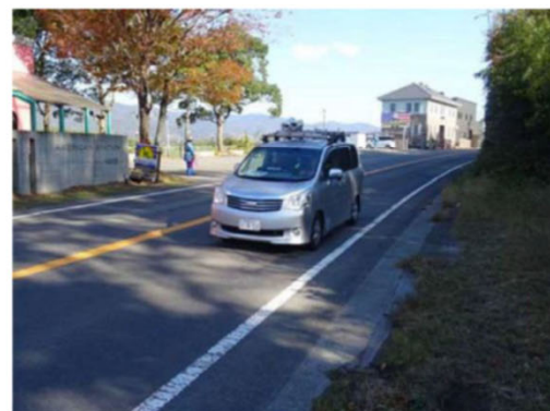
走行しながら測定を行い、ひび割れ率、わだち掘れ率、IRI等を算出
