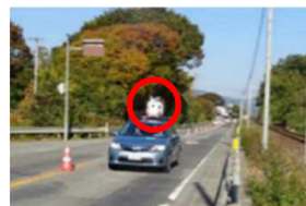
車載装置による路面性状測定
