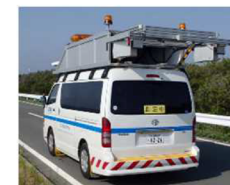
3次元レーザースensa を用いた舗装損傷検知
