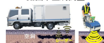
路面下空洞調査
