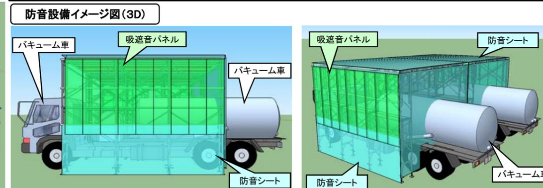
\*バキューム車の音源を防音シートで囲むことで騒音を低減します。
