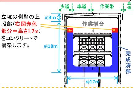
「立坑」とは、シールドマシン(トンネル掘削機)を設置し その発進基地となる縦穴です。工事中の土砂や資材の 搬出入などを行う拠点の役割も兼ねています。
