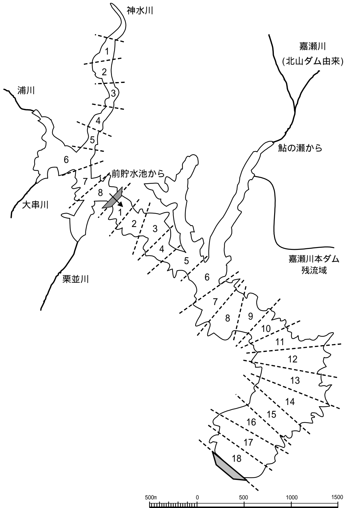
図 4.1.4.2-63 嘉瀬川ダムの平面ブロック分割の模式図
