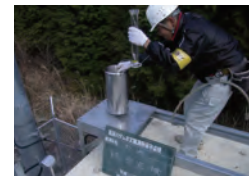
雨量観測所の点検
