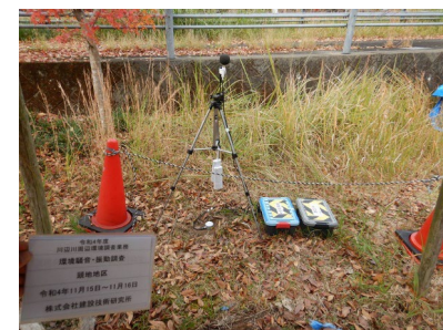
騒音・振動の測定の様子
