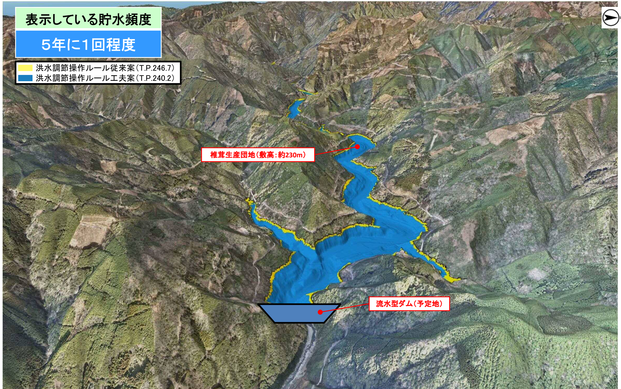
流水型ダムで洪水調節した場合の224洪水実績による貯水範囲【貯水頻度: 5年に1回程度】(ダムサイト付近)
