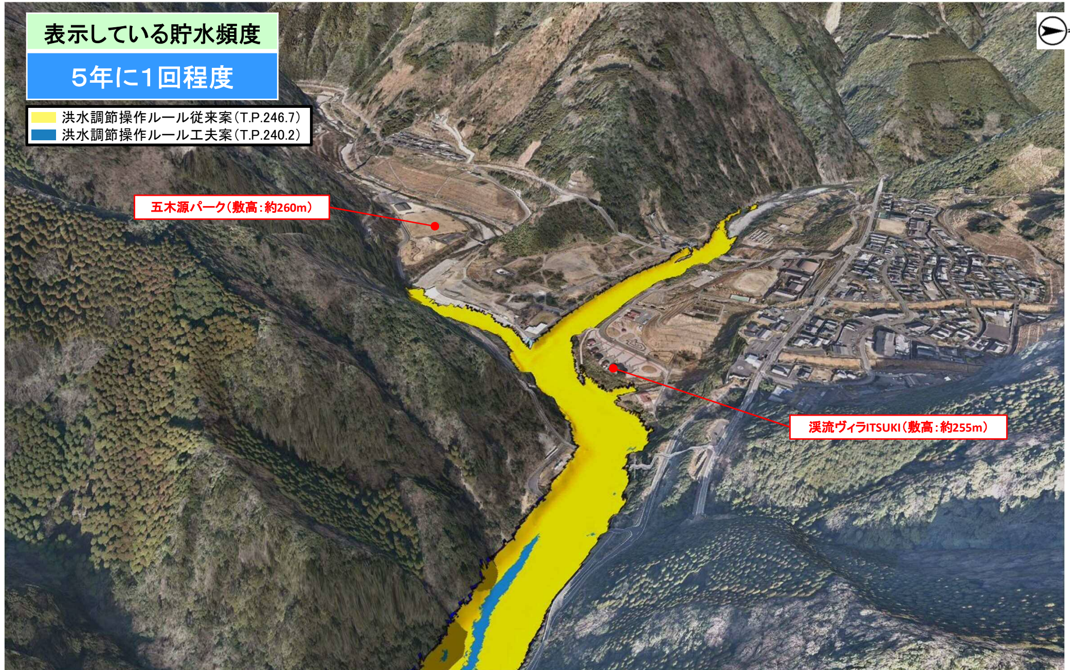
流水型ダムで洪水調節した場合の224洪水実績による貯水範囲【貯水頻度:5年に1回程度】(頭地地区付近)
