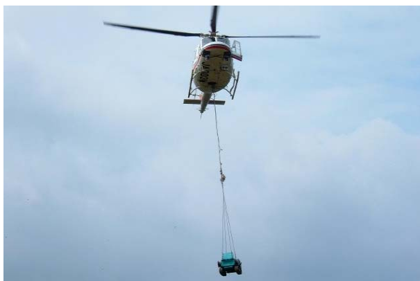
ヘリコプターによる建設機械の輸送状況
