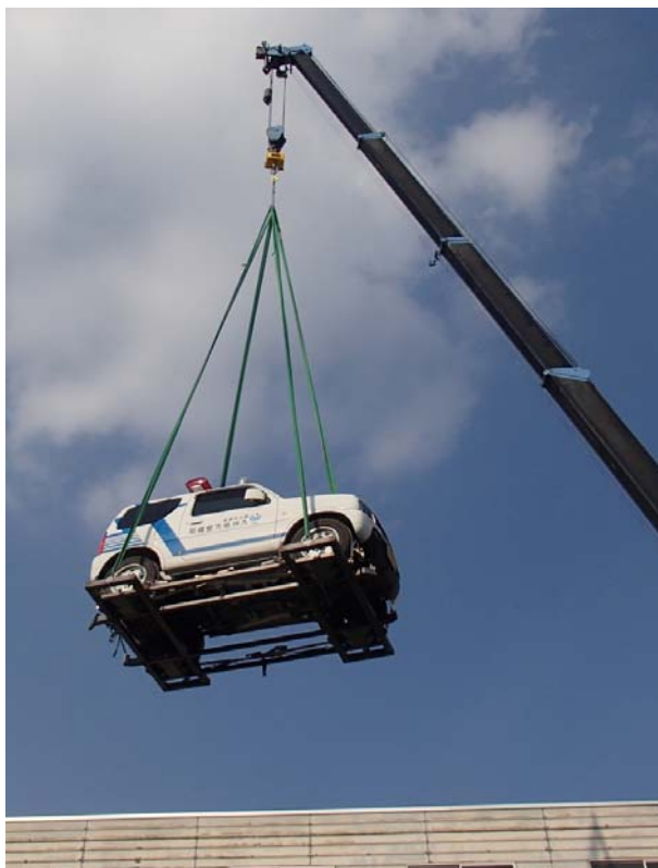
砂防パトロールカー地上での吊り下げ試験状況 ※当日は、ヘリコプターでの吊り下げ試験を行います。
