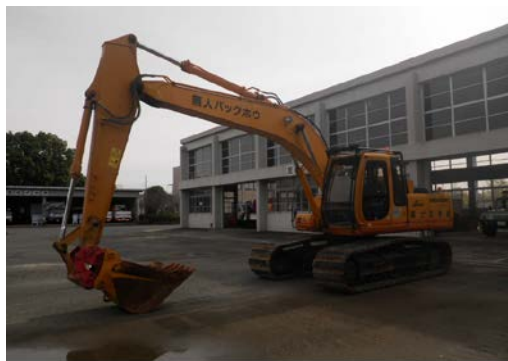
遠隔操縦式バックホウ(九州技術事務所)
