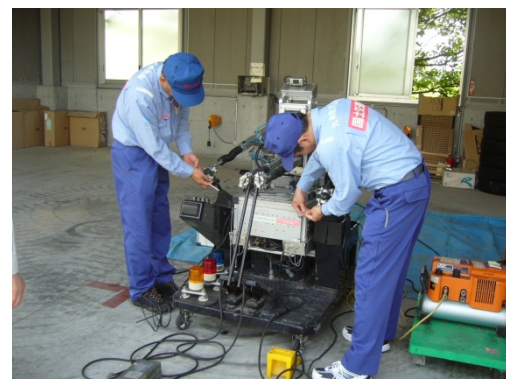
簡易操縦遠隔操縦装置(ロボQ)組立状況
