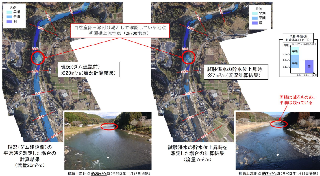
図 3-9 河川流量の減少によるアユ産卵場の環境変化 (左: 20\text{m}^3/\text{s} 時、右: 7\text{m}^3/\text{s} 時)
