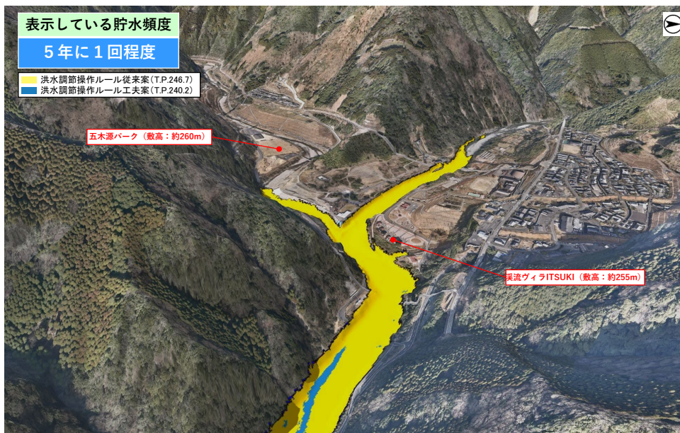
図 4-12 5年に1回程度の貯水範囲の従来案・工夫案の比較図（頭地地区付近）
