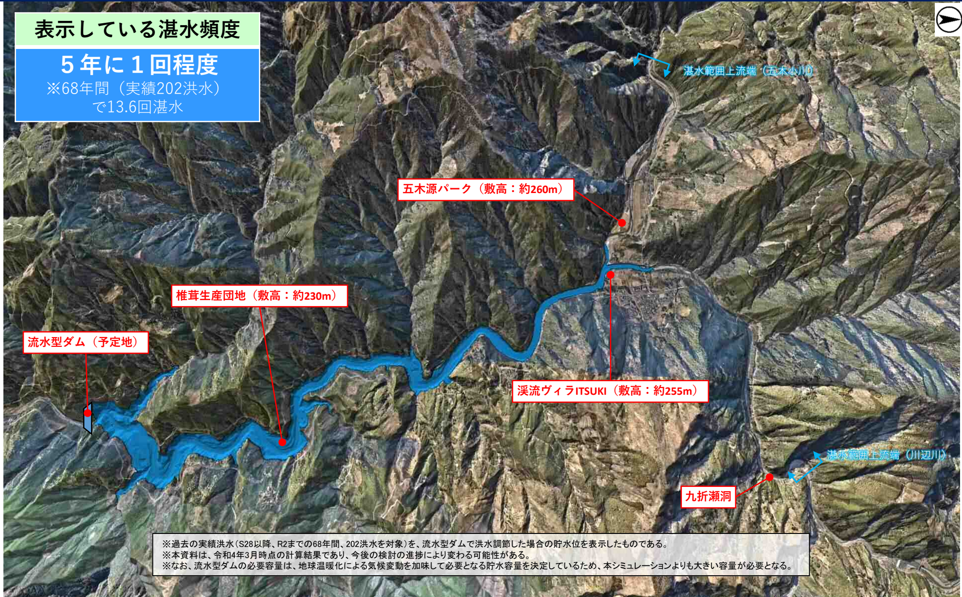
流水型ダムで洪水調節した場合の202洪水実績による湛水範囲【湛水頻度：5年に1回程度】(全景)
