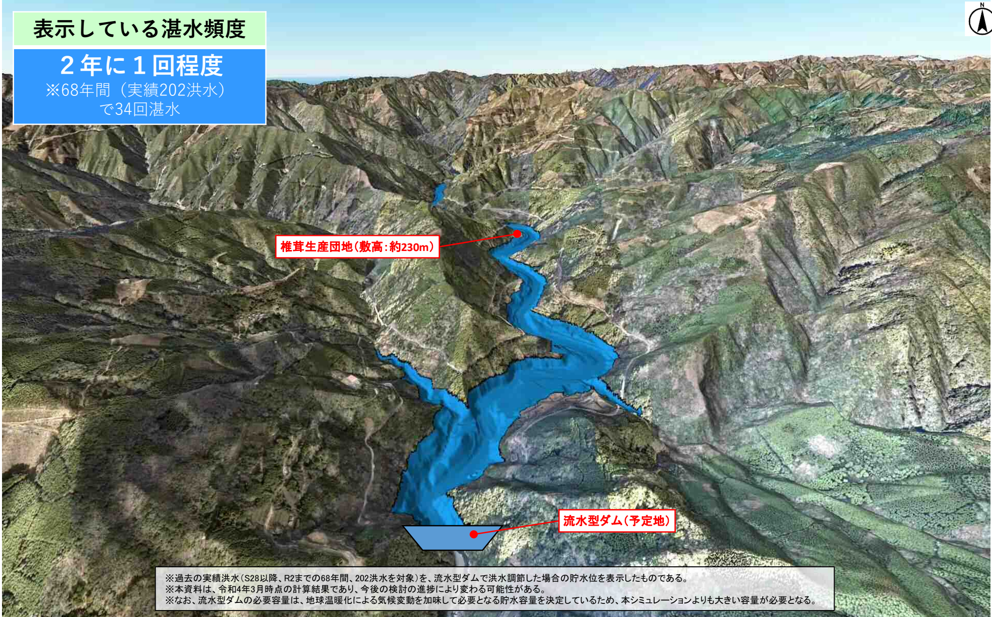
流水型ダムで洪水調節した場合の202洪水実績による湛水範囲【湛水頻度:2年に1回程度】(ダムサイト付近)
