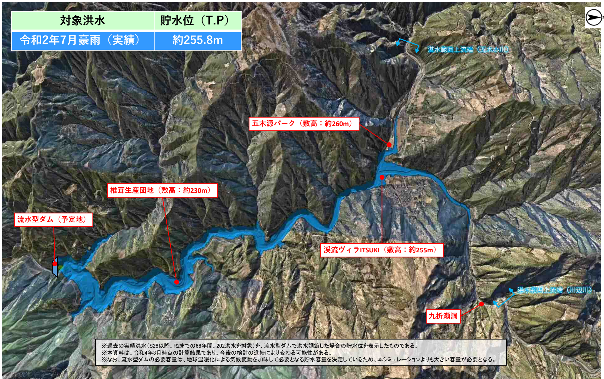
流水型ダムで洪水調節した場合のR2.7洪水の実績湛水範囲 (全景)
