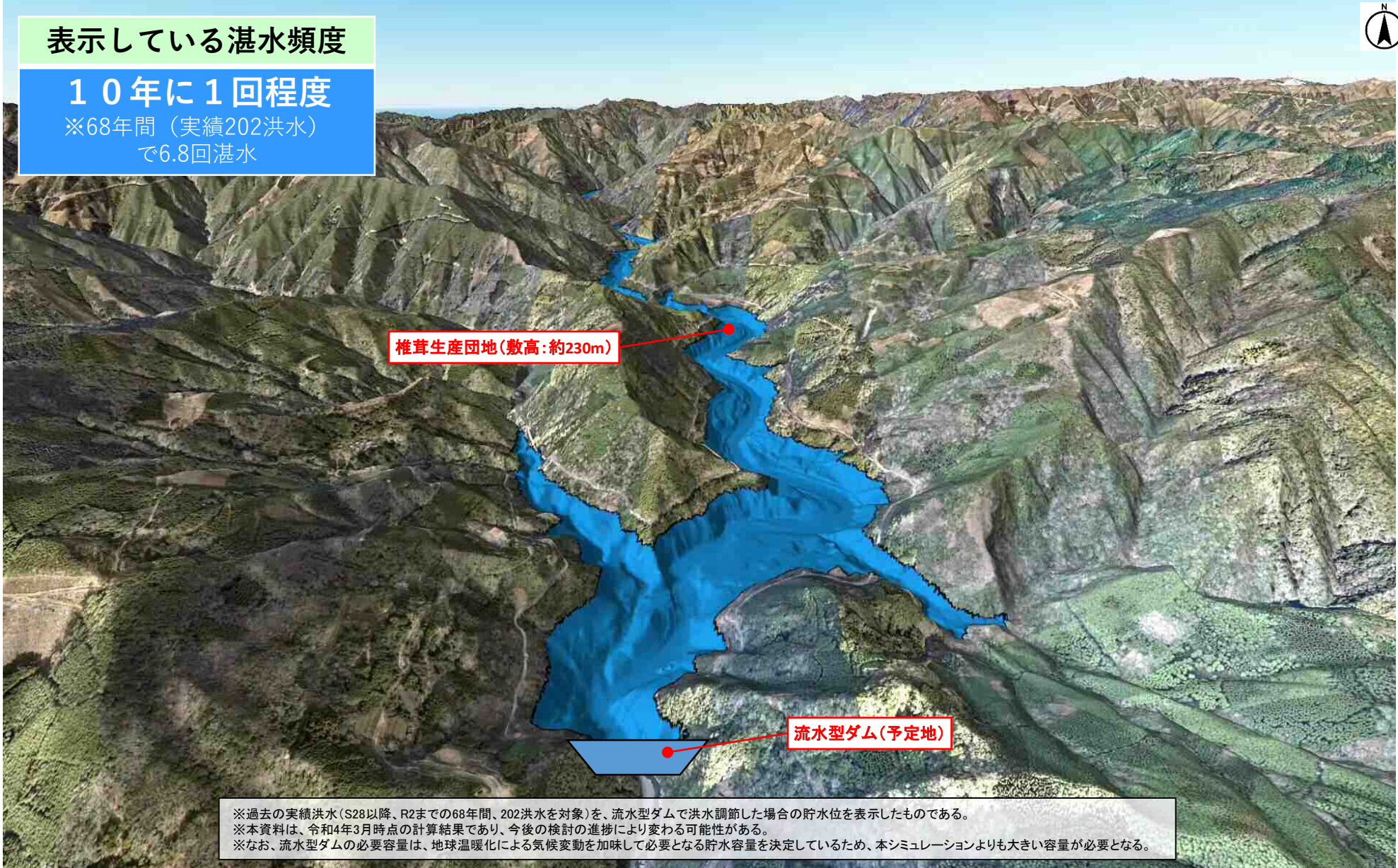
流水型ダムで洪水調節した場合の202洪水実績による湛水範囲【湛水頻度:10年に1回程度】(ダムサイト付近)
