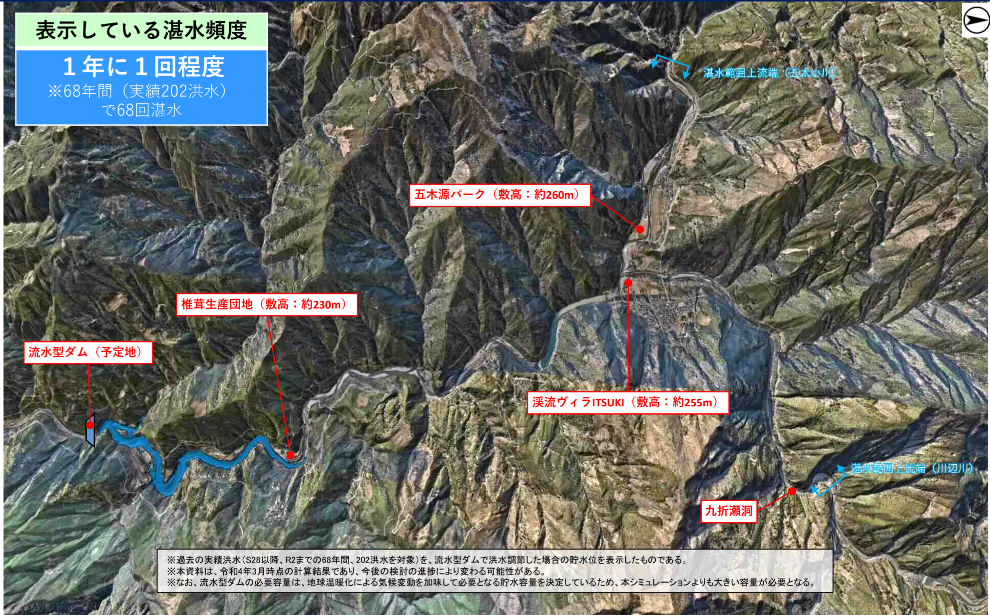
流水型ダムで洪水調節した場合の202洪水実績による湛水範囲【湛水頻度：1年に1回程度】(全景)
