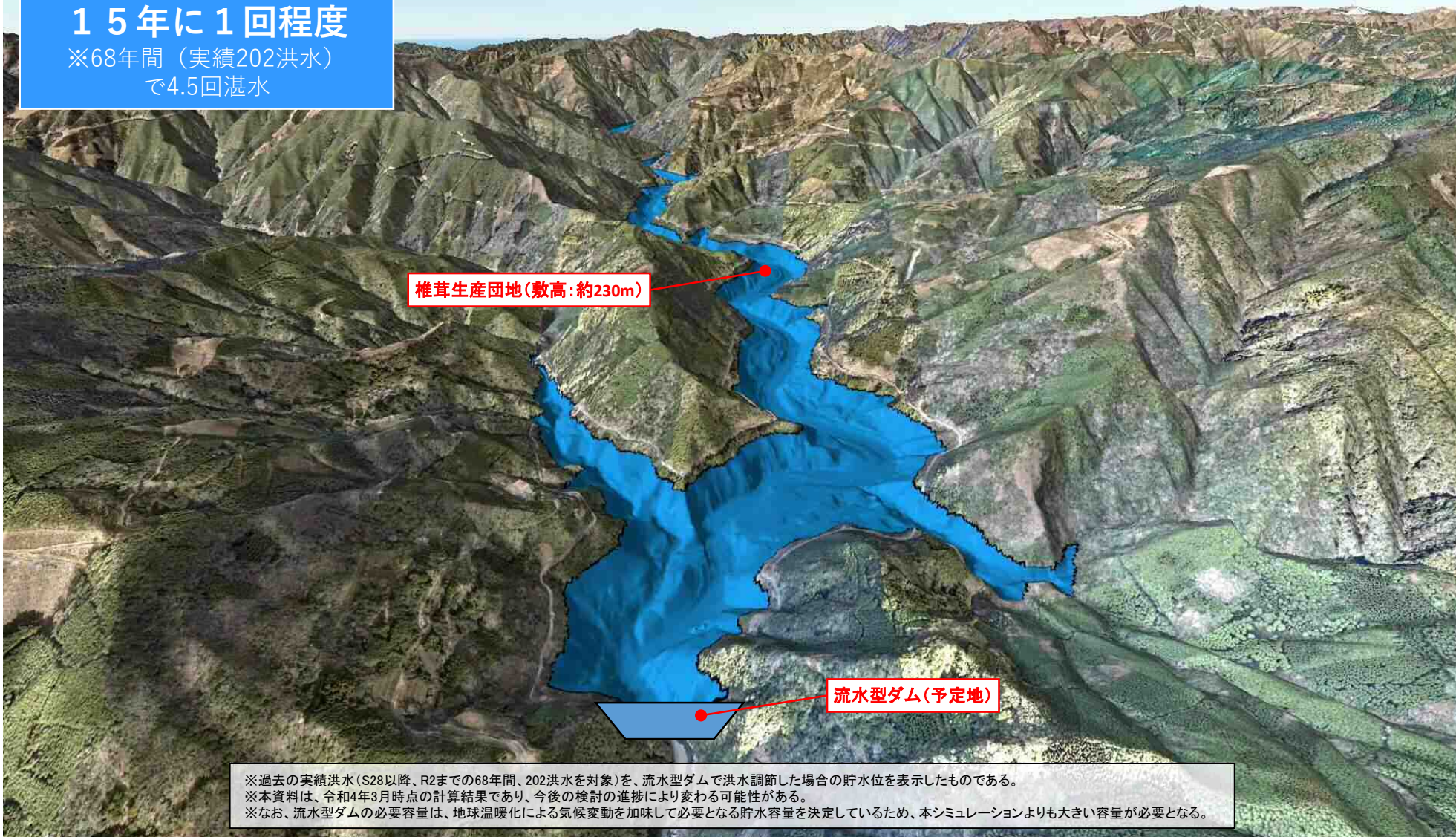
流水型ダムで洪水調節した場合の202洪水実績による湛水範囲【湛水頻度:15年に1回程度】(ダムサイト付近)
