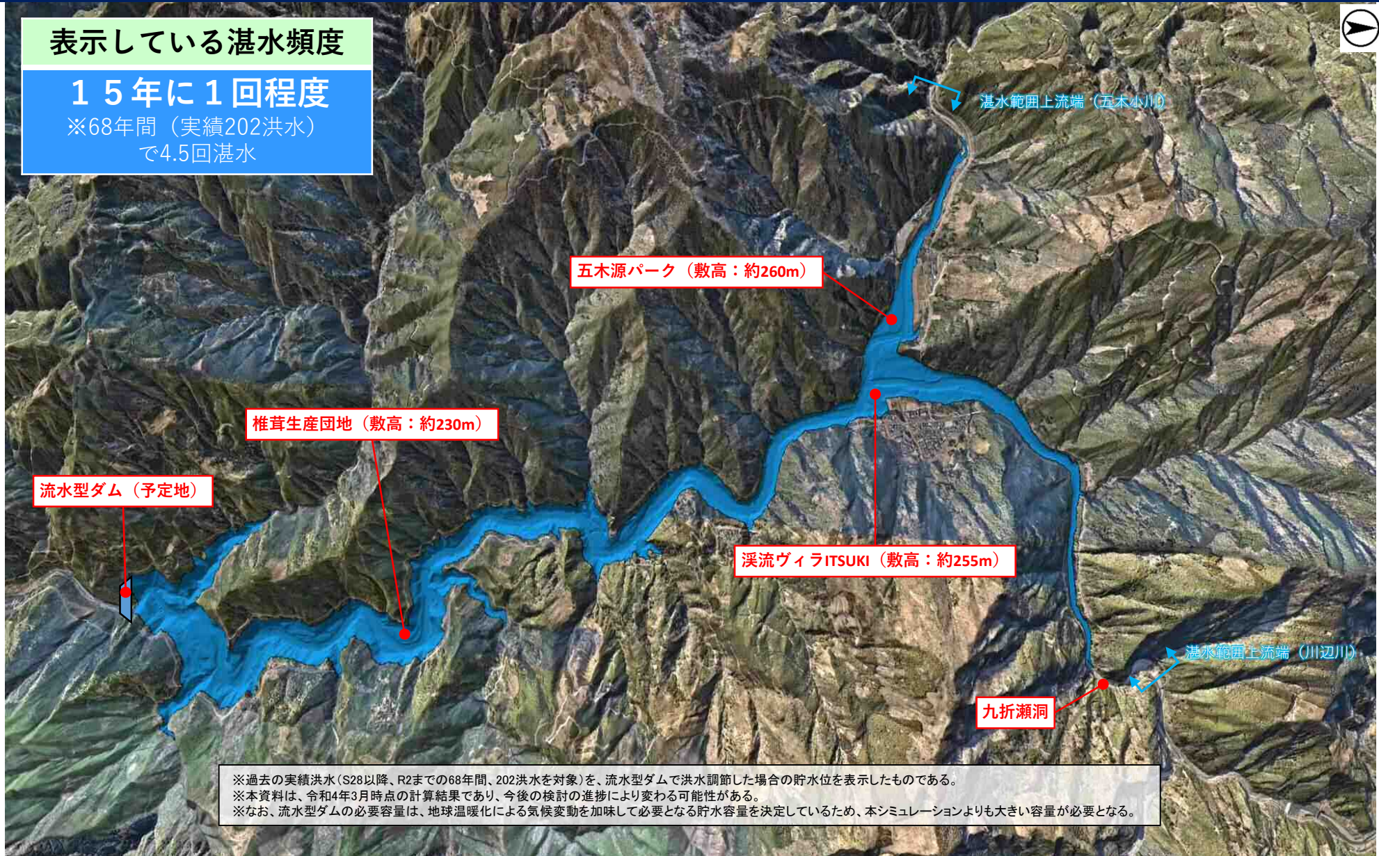
流水型ダムで洪水調節した場合の202洪水実績による湛水範囲【湛水頻度：15年に1回程度】(全景)
