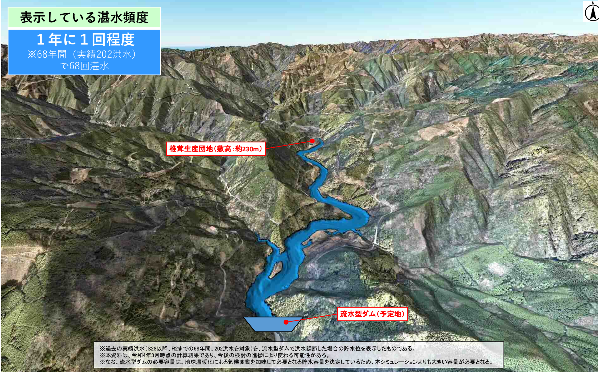
流水型ダムで洪水調節した場合の202洪水実績による湛水範囲【湛水頻度:1年に1回程度】(ダムサイト付近)
