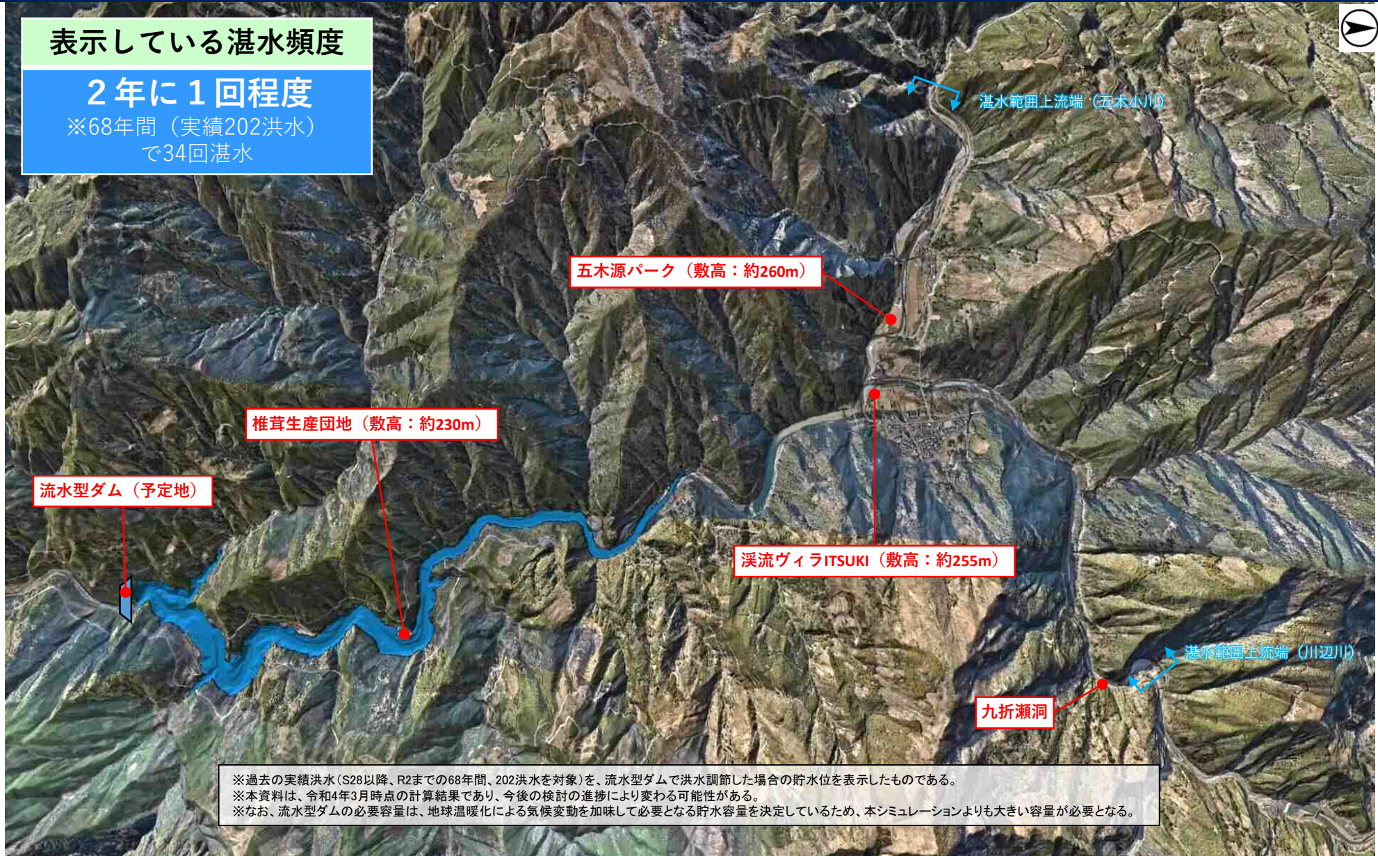
流水型ダムで洪水調節した場合の202洪水実績による湛水範囲【湛水頻度：2年に1回程度】(全景)
