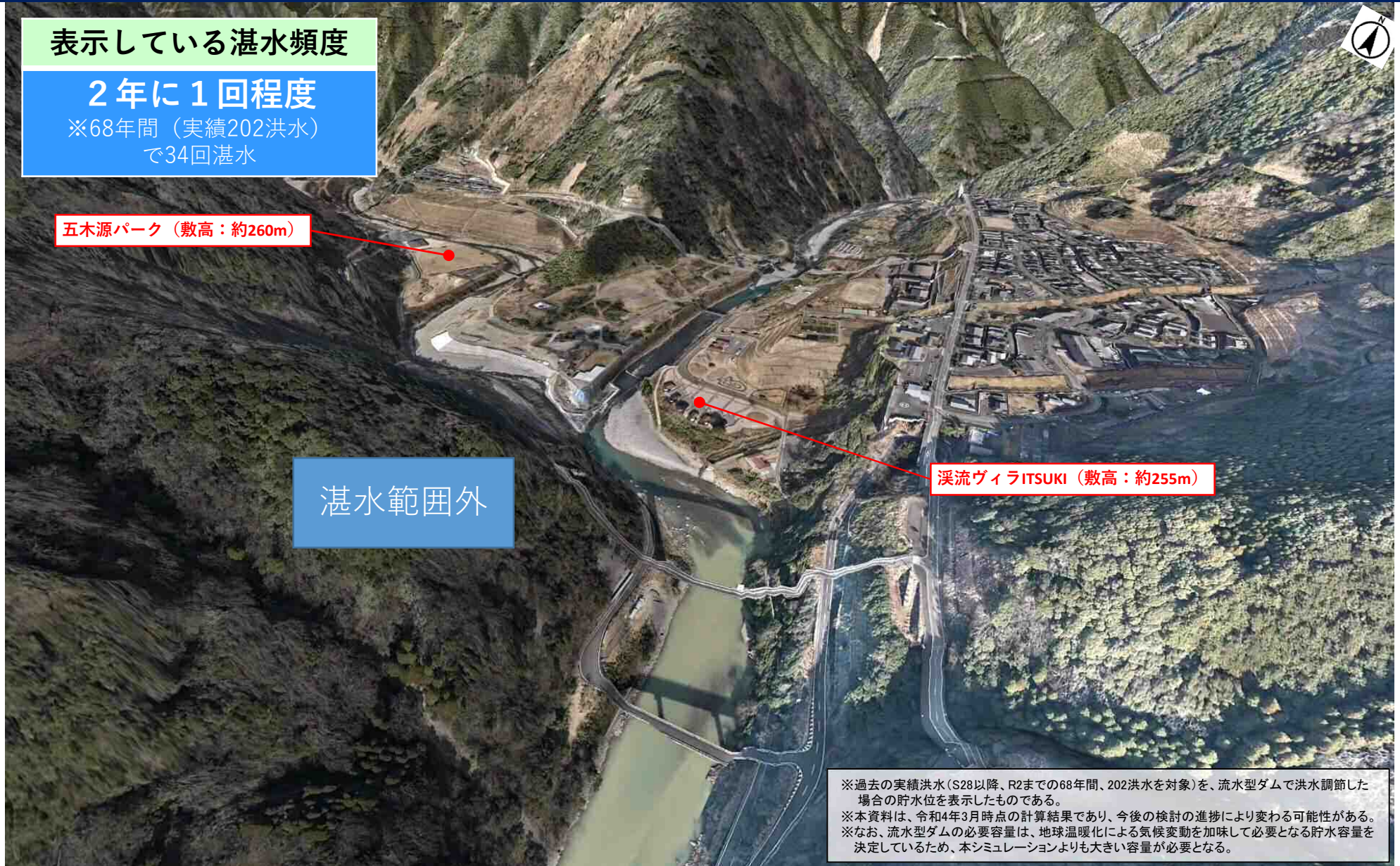
流水型ダムで洪水調節した場合の202洪水実績による湛水範囲【湛水頻度：2年に1回程度】（頭地地区付近）
