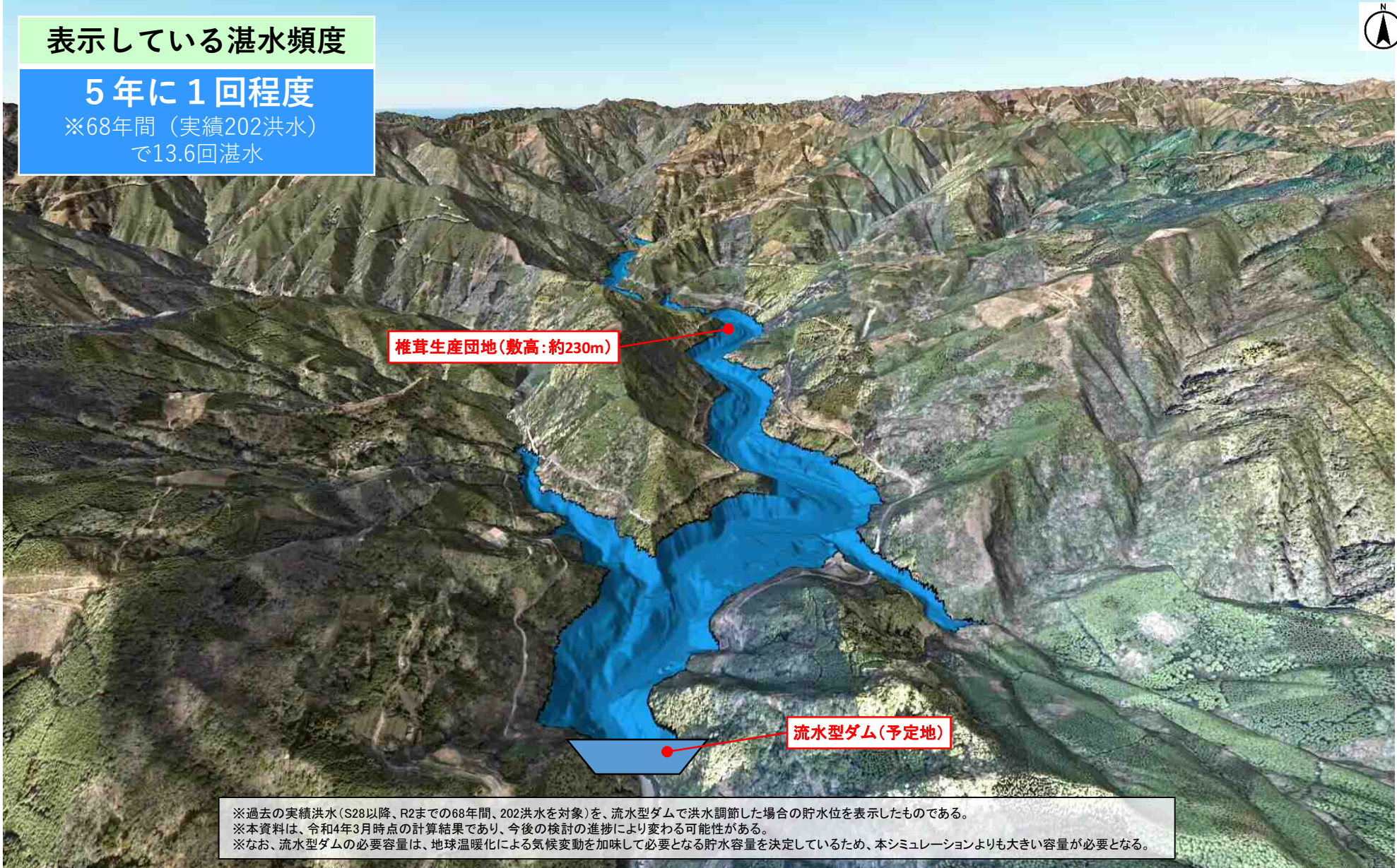
流水型ダムで洪水調節した場合の202洪水実績による湛水範囲【湛水頻度:5年に1回程度】(ダムサイト付近)
