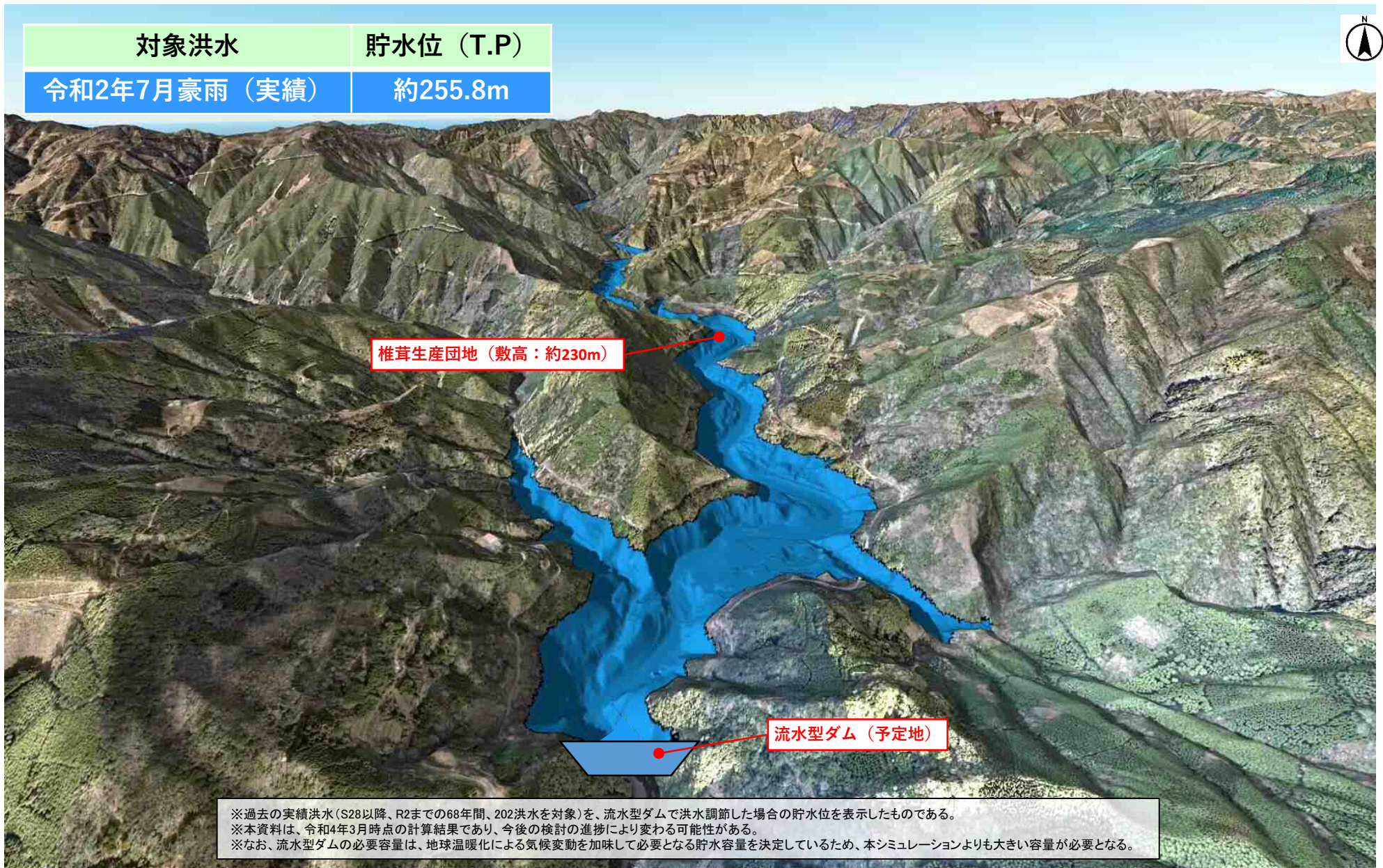
流水型ダムで洪水調節した場合のR2.7洪水の実績湛水範囲 (ダムサイト付近)
