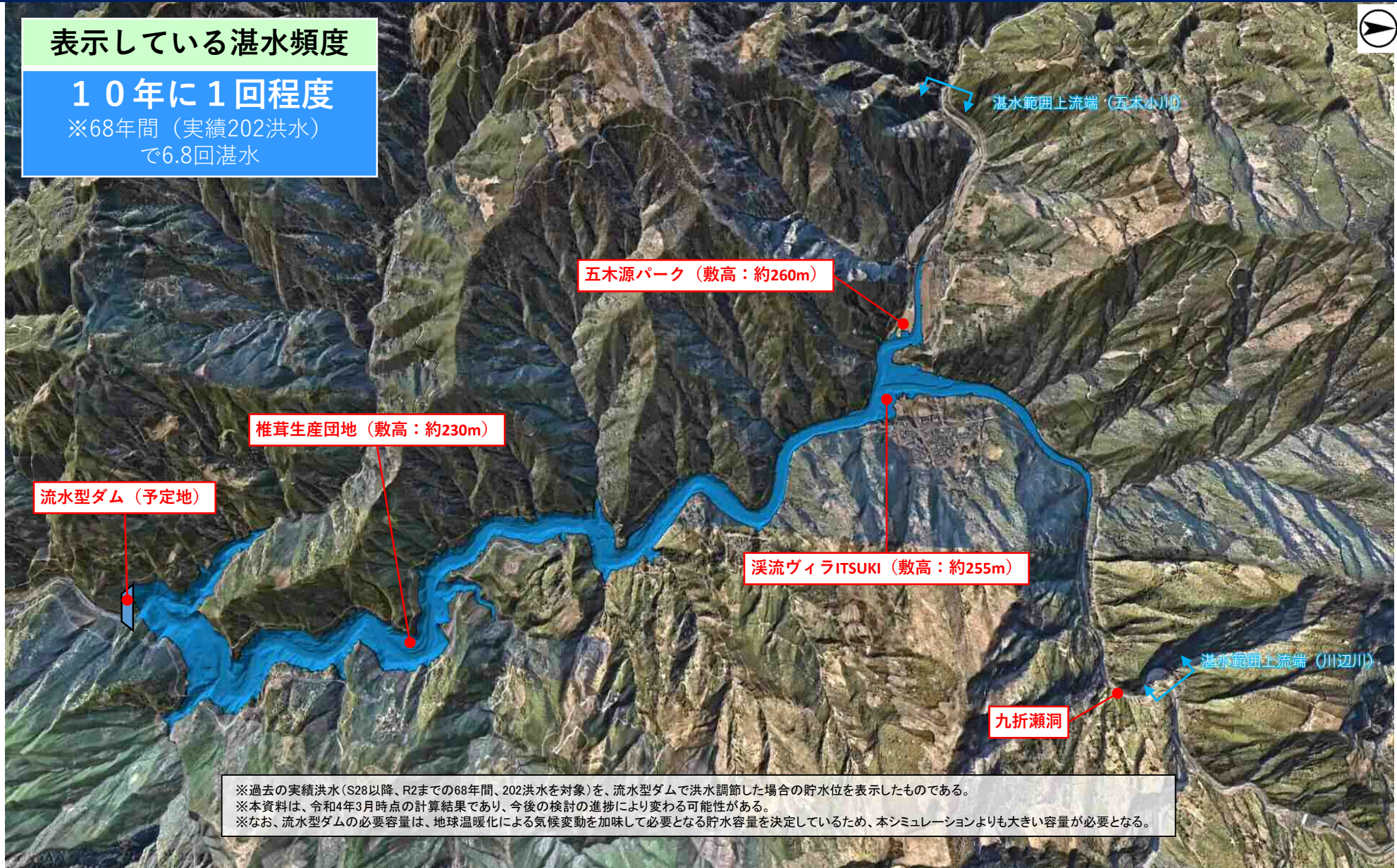
流水型ダムで洪水調節した場合の202洪水実績による湛水範囲【湛水頻度：10年に1回程度】(全景)
