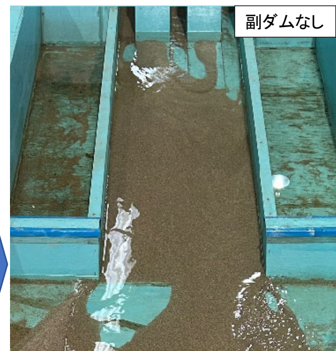
減勢工内に適度に石礫が堆積しており、河床環境の連続性が保持されている。
