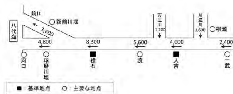
図 2.4-3 球磨川計画高水流量図（単位： \text{m}^3/\text{s} ）
