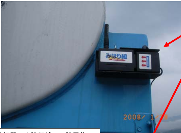
警報器の建設機械への設置状況
