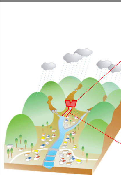
砂防堰堤 平水時は土砂を安全に下流へ流下させ、洪水時は異常な土砂流出を抑制します。
