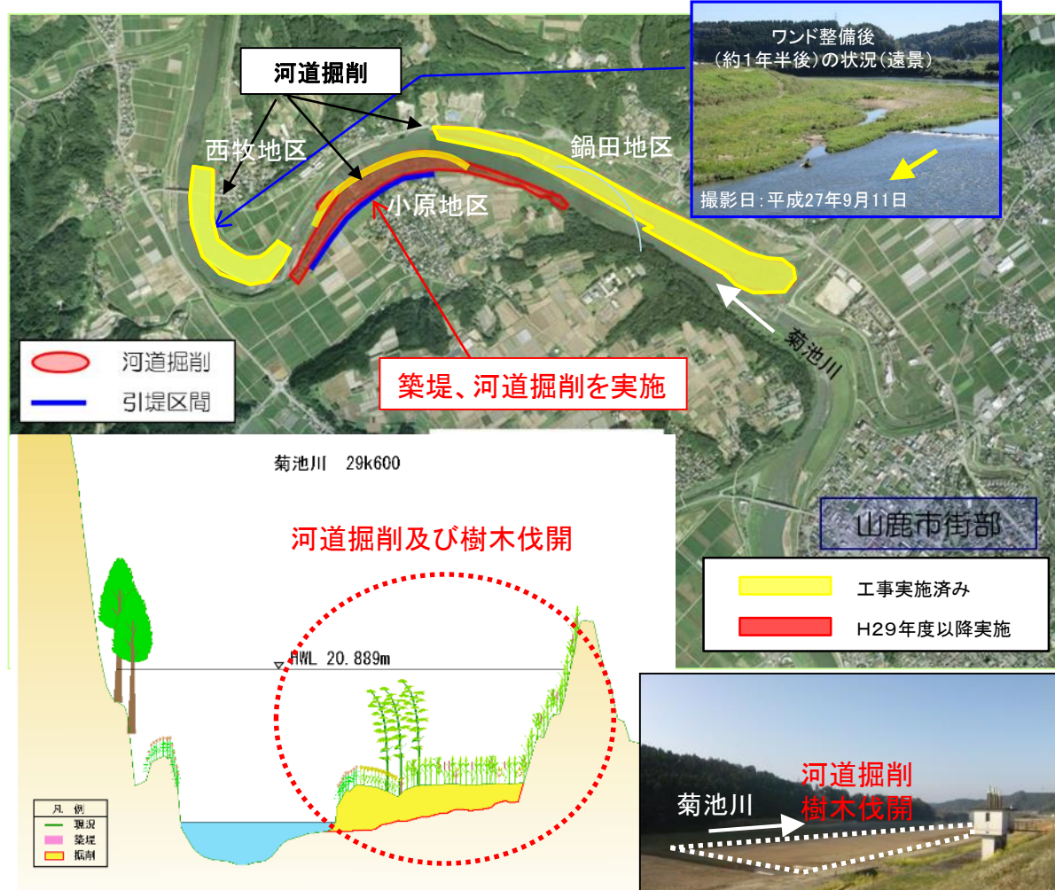
鍋田地区における河道掘削
