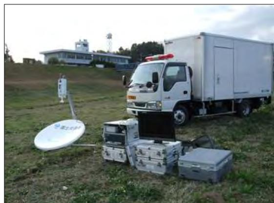
写真 2.1.17 ku-SAT と運搬車
