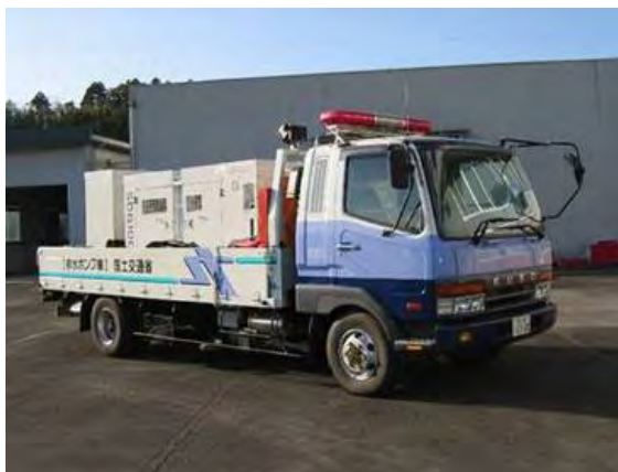
写真 2.1.16 排水ポンプ車
