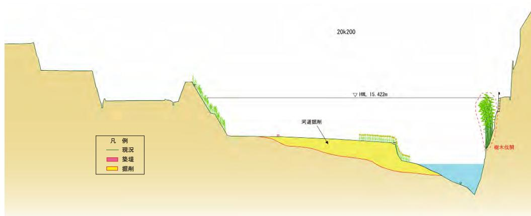
図 4.2.2 河道掘削のイメージ図
