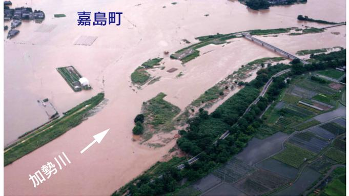
梅雨前線の影響に伴い、平成9年7月8日から11日にかけて、激しい雨が断続的に降り続けました。緑川流域においても津森雨量観測所では1時間に47mm、総雨量917mmを観測し、加勢川の大六橋水位観測所では**計画高水位を約10cm上回る5.00m**に達しました。
