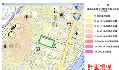
多段階浸水想定区域図検討時の内水のみ結果(1/150)
