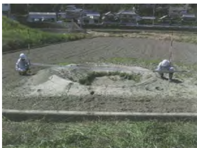
漏水による噴砂の例
