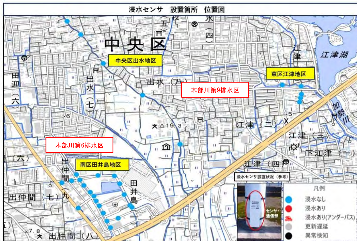
▲ワンコイン浸水センサの設置状況
