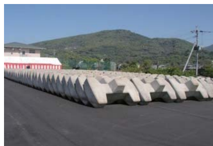
水防資材の備蓄状況
