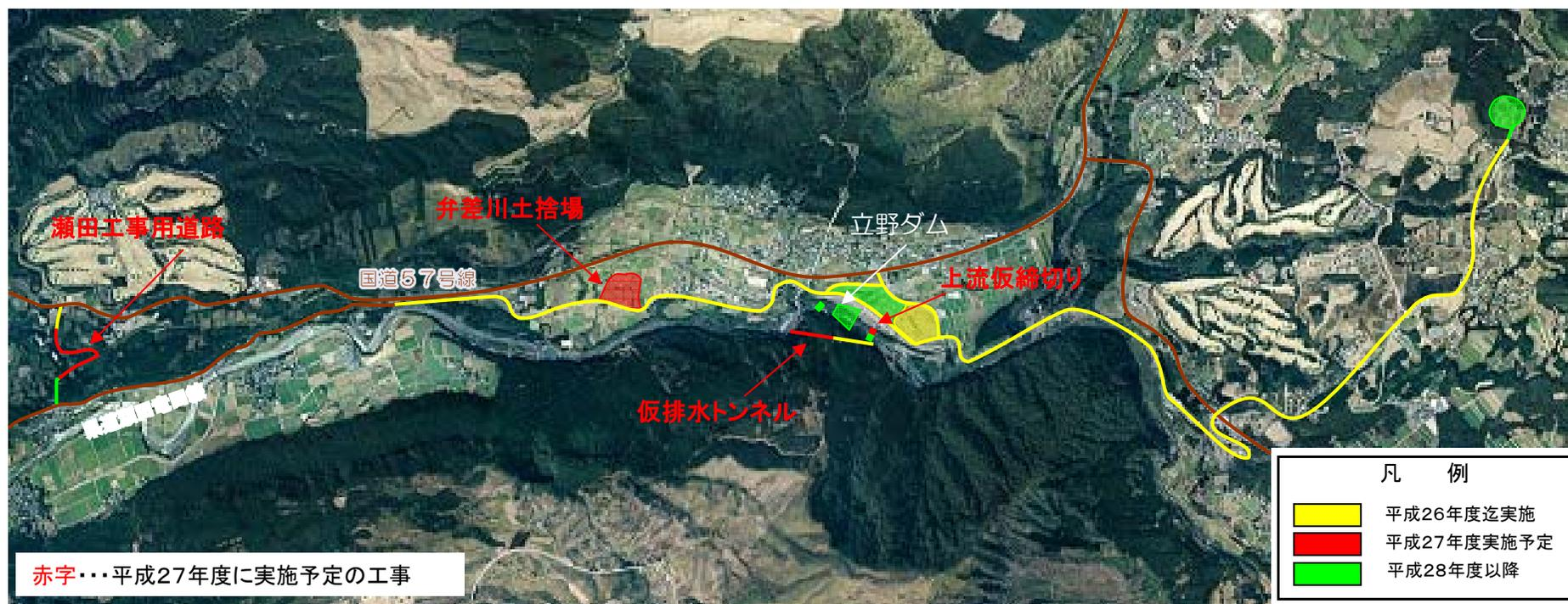
仮排水トンネルとは、ダム本体工事を行うために、一時的に川の流れを切り替える工事です。
