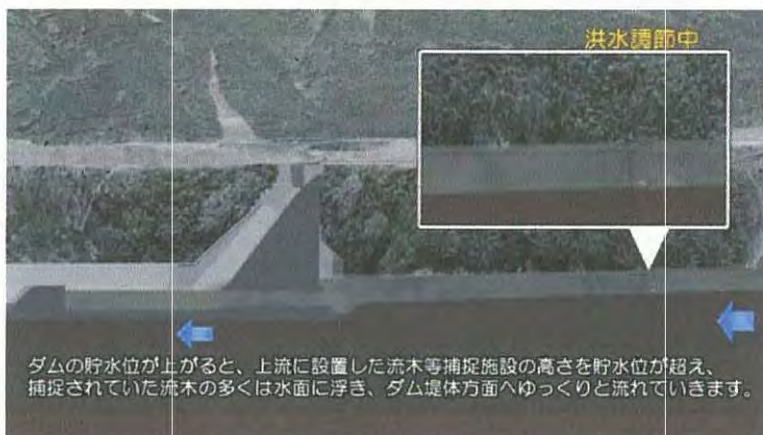
国交省動画「立野ダムの洪水調節」より ダムの水位が流木等捕捉施設を超え、流木がダム本体へ向かう状況。上段の放流孔(穴)は全く水没していない。
