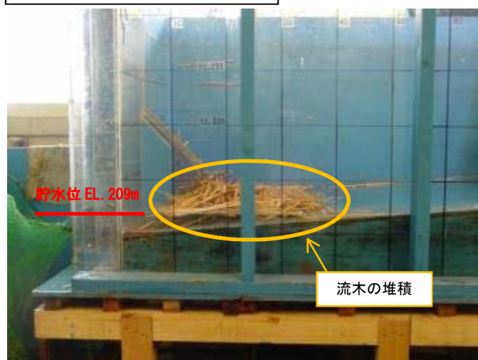
写真－5 水理模型実験の状況
