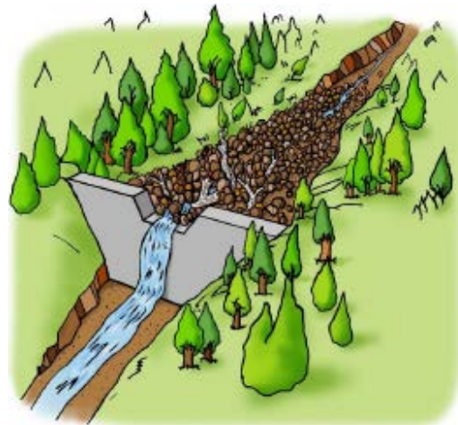
不透過型砂防堰堤
