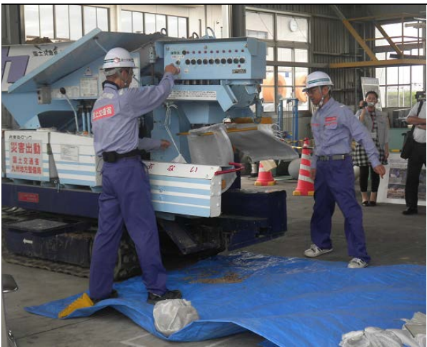
技術開発調査 (土のう造成機 操作実演)
