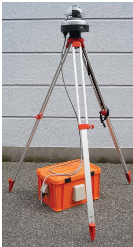
図3：配信端末、三脚、バッテリーキットの設置イメージ
