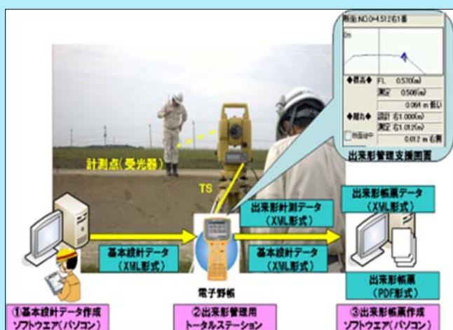
(TLSによる出来計測のイメージ)
