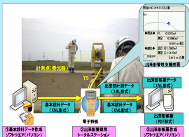
(TLSによる出来形計測のイメージ)
