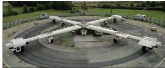
輪荷重走行試験 (フランス)
