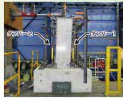
ダンパーを設置した橋脚の実験状況
