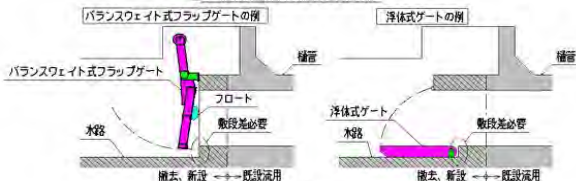
図2 新技術「下部水密可動式無動力自動開閉ゲート」
