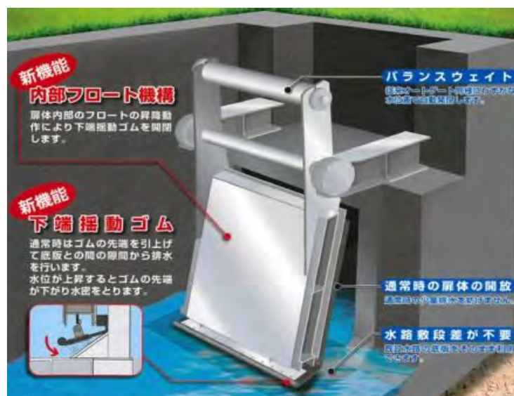
図1 従来の既設極門の無動力自動化改修
