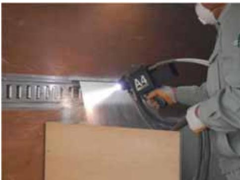
A4溶射ガンの試験溶射
