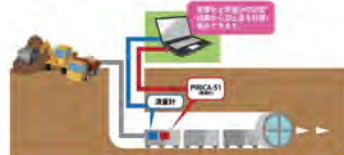
シールド工法での排出土量のモニタリング
