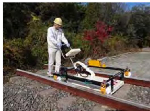
線路下空洞探査装置
