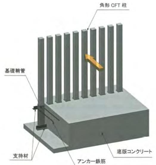
図-2 VCCO型堰堤の構造概念
