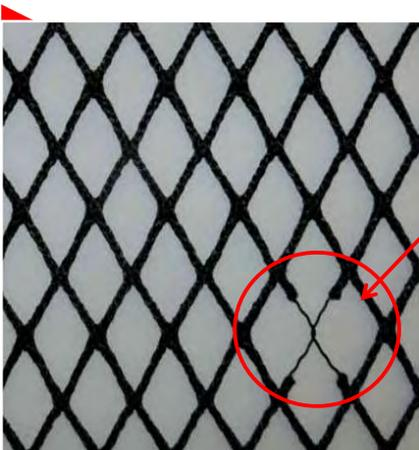
○ポリエステル製ラッセル網の芯材としてモノフィラメントを挿入
