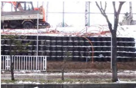
写真-2 凍上性確認試験 (北海道北見市)
