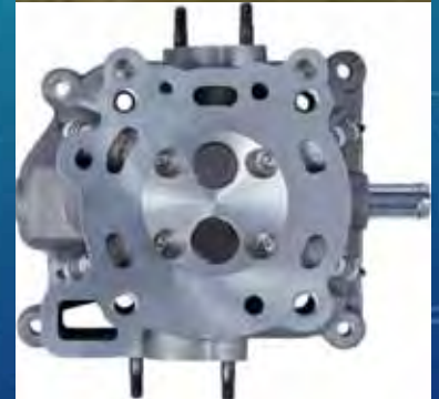
四点点火方式による急速燃焼
