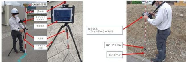
GNSS観測に採用される新技術の機材構成
