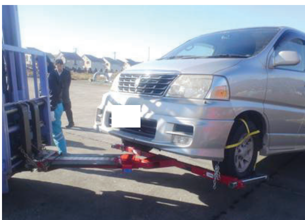
前輪脱輪防止部材取付
