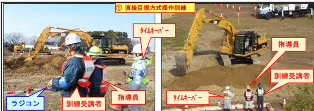
バックホウから離れた場所(側方や前方)で、直接目視での遠隔操作訓練を行いました。前面からの操作ではラジコンのレバー操作方向とバックホウの稼働方向が逆になり、操作がむずかしくなります。
