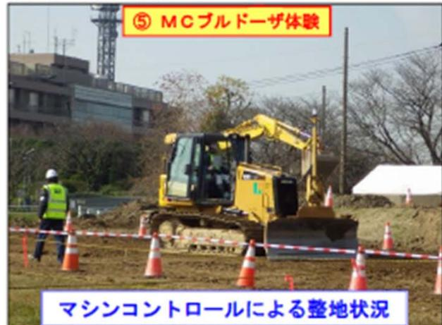
自動整地アシスト制御により自動で所定の地盤高に整地できます。
