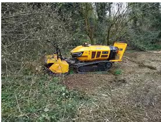
直径10センチまでの灌木の刈払いができるフォレストアタッチメント
