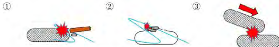
図1.既存袋詰め玉石工の破損要因
