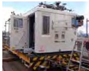
モーターカーに搭載 されるMIMM機材室
